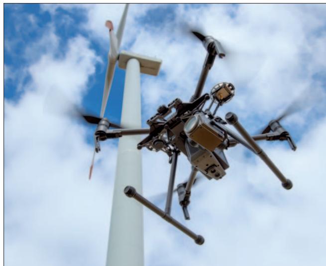
Drohnen ermöglichen Inspektionen an schwer zugänglichen Stellen wie es Rotorblätter sind.
