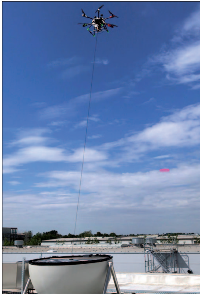
Stationäre Drohne mit Stromkabel verbunden.
